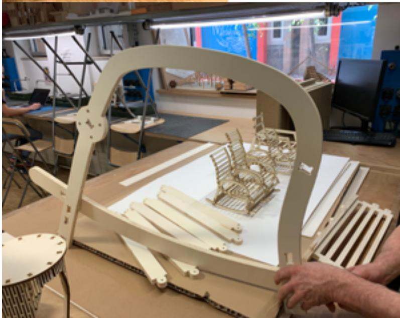
▲ Assemblage des pièces à l'atelier maquettes dans le cadre du cours de Master 1 «Analyse constructive par la maquette : conception et réalisation de mobiliers assemblés sans colle ni clous ni vis, découpés à la fraiseuse numérique» © DR
